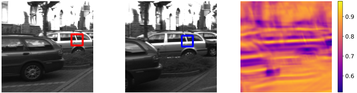
Figura 4.5: Ejemplo de seguimiento por correlación. El cuadrado rojo de la imagen de la izquierda marca la plantilla a buscar. La imagen del centro es la ventana de búsqueda, siendo el cuadrado en azul la localización emparejada por el algoritmo. El mapa de calor de la derecha muestra el valor de la correlación en cada punto de la ventana de búsqueda, siendo el valor más alto el que corresponde a las coordenadas del cuadrado azul.
