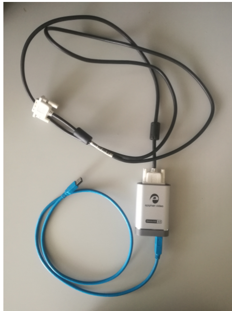
(c) Tarjeta DVI2USB 3.0: con cables DVI y USB 3.0 conectados
