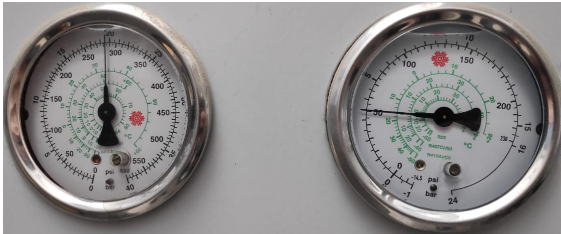
Figura 25: Medida de presión con manómetros del equipo.
