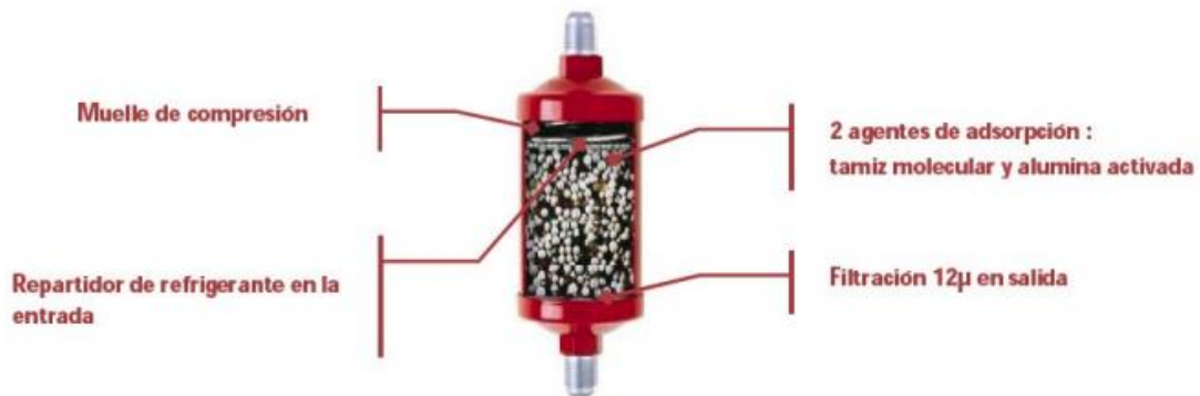
Figura 49: Interior de un filtro deshidratador.
