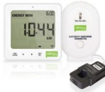
Figura 28: Medidor Efergy E2 Classic. Fuente: EFERGY.
