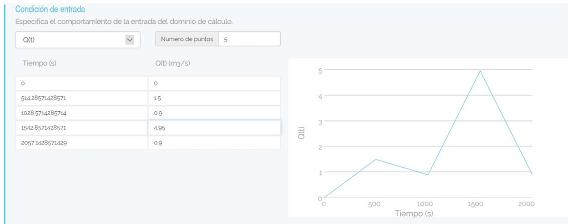
Figura 18: Opciones disponibles para definir el flujo a la entrada del canal a simular en *Canalflowmodel*.
