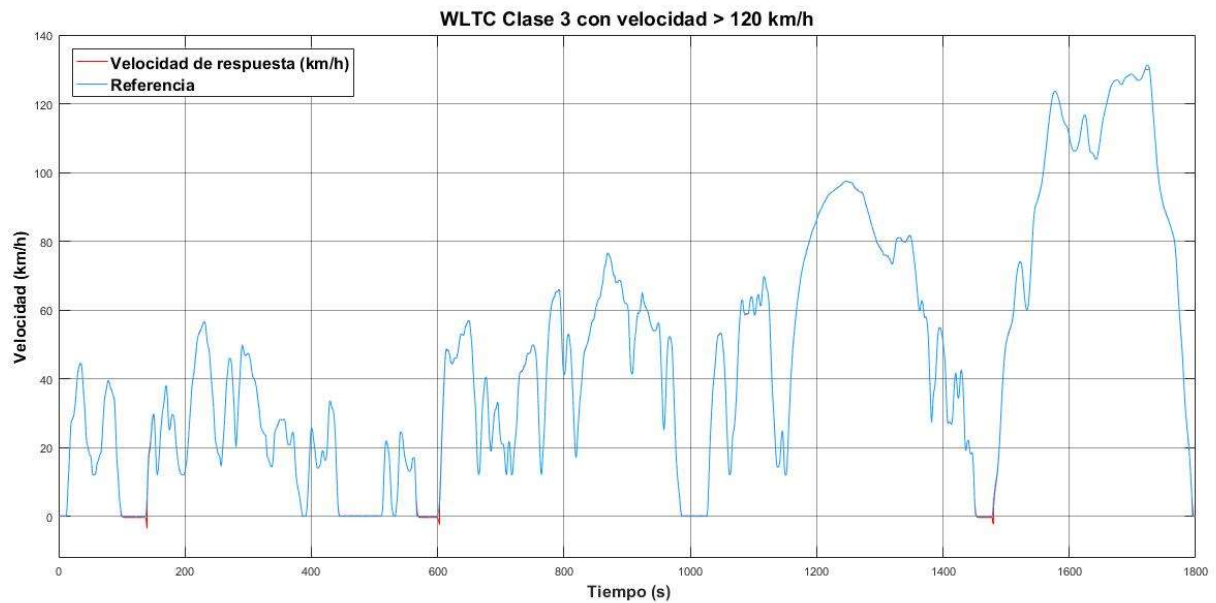
Figura 58 Comparativa de la referencia del ciclo WLTC clase 3 con velocidad superior a 120 km/h, con la velocidad dada por el motor en Simulink.
