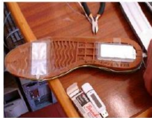
Ilustración 10: Dos piezoeléctricos PVDF (polifluoruro de vinilideno) colocados en la suela de un zapato en los puntos de mayor y más variable presión. (Sepúlveda Orozco, 2014)
