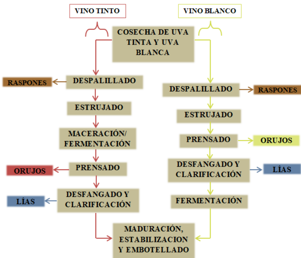
Figura 5. Proceso de elaboración del vino. Principales operaciones en las que se generan los diferentes residuos
