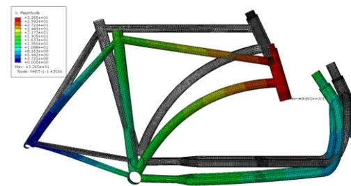
Imagen 5.3: Distribución de desplazamientos máximos sobre el ensamblaje completo
