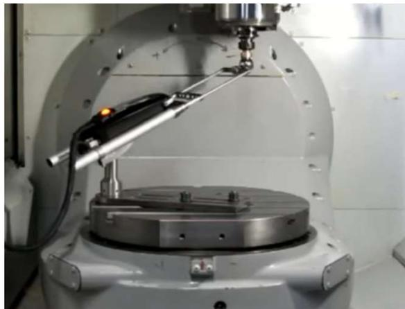
*Ilustración 3.3-1 Sistema láser-tracer*
