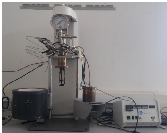
Figura 8. Reactor tipo Batch usado para la despolimerización de la lignina.
