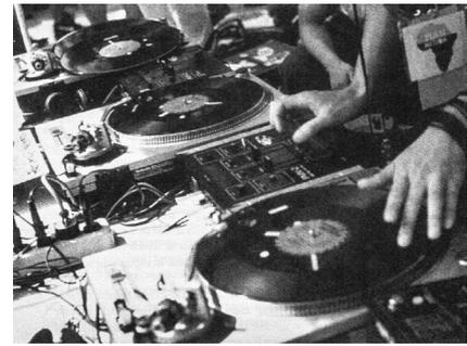
Figura 60. Fotografía del sistema usado por los DJ. A los lados, dos tocadiscos que reproducen la pista musical base, y en el centro, la mesa de mezclas, que permite alternar la música proveniente de los dos tocadiscos.
