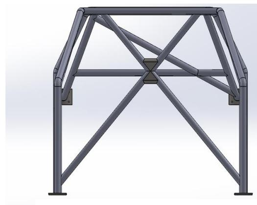
Figura 26: Alzado jaula antivuelco
