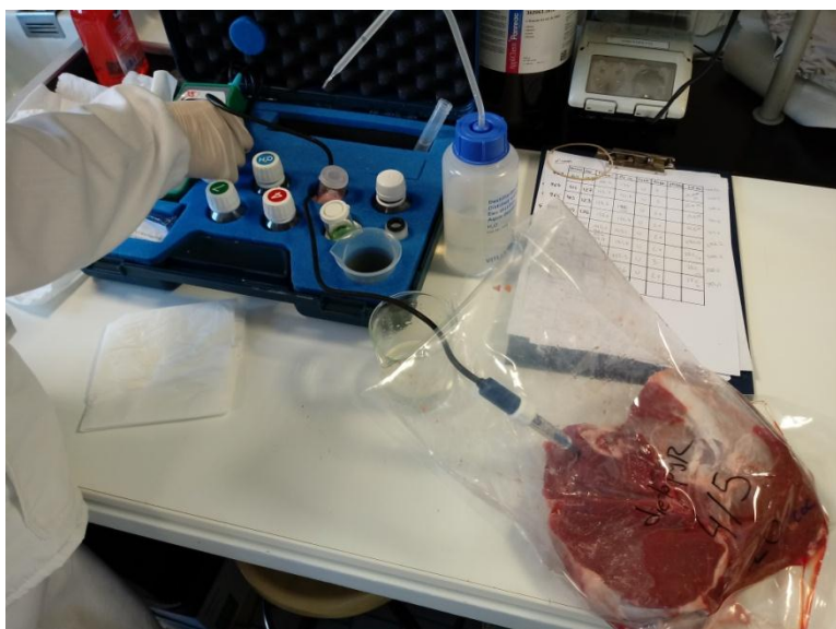
Figura 5. Medición del pH en el Lomo
