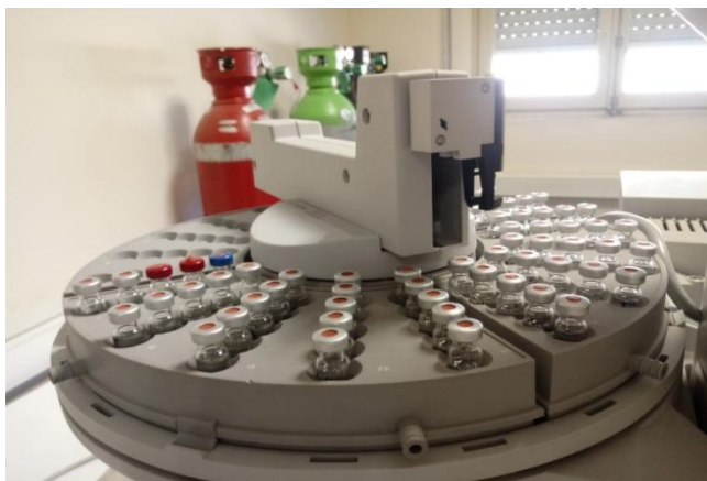
Figura 7. Análisis de los ésteres metílicos de los ácidos grasos (cromatógrafo de gases HP 6890)
