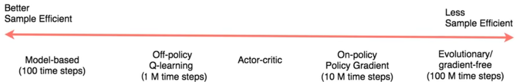
Figura 3.3: División de métodos de (Deep) Reinforcement Learning y su eficiencia en cuanto al número de datos necesarios para aprender. Adaptado de (Fridman, 2019).
