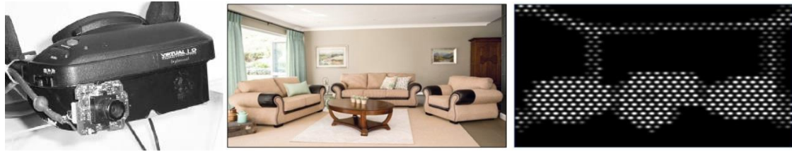
Figura 12. Izquierda: una de las configuraciones de sistema para la simulación de la visión protésica, compuesto por una microcámara y dos monitores (9). Centro: fotografía de un salón obtenida por una cámara convencional. Derecha: simulación de la visión protésica para la imagen anterior (10).
