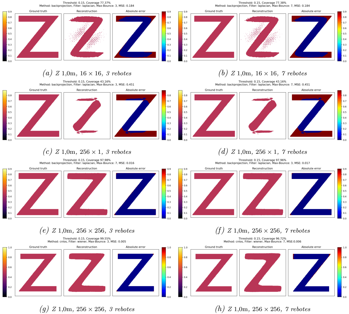
Figura A.2: Reconstrucciones de una escena sencilla con una letra plana flotando frente al muro visible. Vemos que la calidad de las reconstrucciones varía con el patrón de captura (en los casos con captura única se pierde gran parte de la reconstrucción al elegir un valor umbral demasiado elevado), pero el número de rebotes no afecta al resultado. La mayoría de métodos de reconstrucción asumen que la luz proviene únicamente de un tercer rebote, reforzando el uso de este tipo de escenas en trabajos previos.
