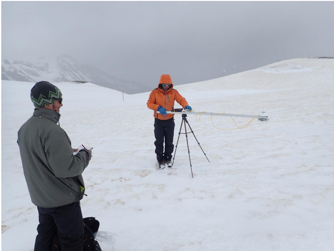
Figura 23: Medición del albedo in situ el día 14/05/2018 Fuente: IPE
