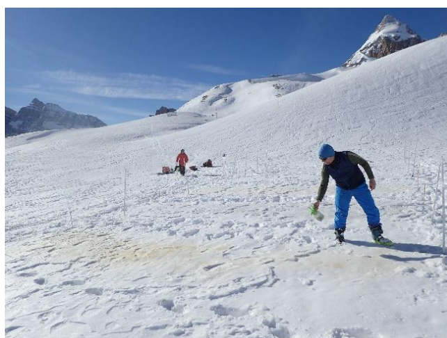
Figura 12: Esparcimiento de las impurezas sobre la nieve. Fuente: IPE
