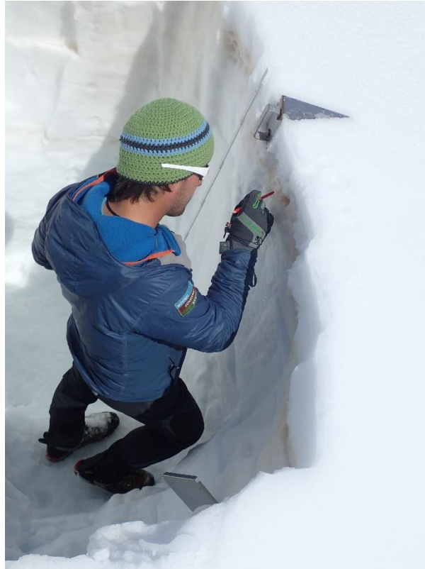
Figura 17: Medición del tamaño del grano de nieve. Fuente: IPE
