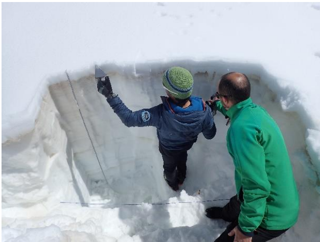
Figura 15: Extracción de nieve con la cuña. Fuente: IPE
