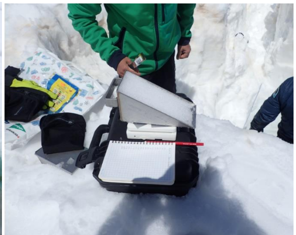
Figura 16: Pesaje de la cuña con nieve para obtener la densidad. Fuente: IPE
