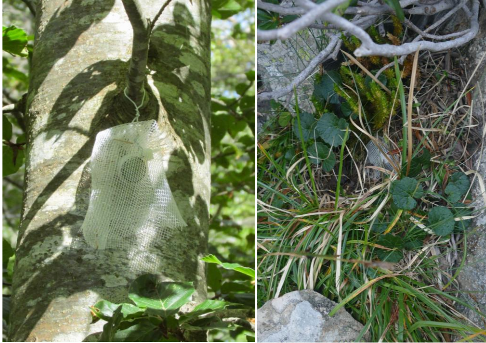
Figura 3.4. Sensores iButton ® con protección de malla mosquitera. Izda: en árbol; Dcha: en roquedo.
