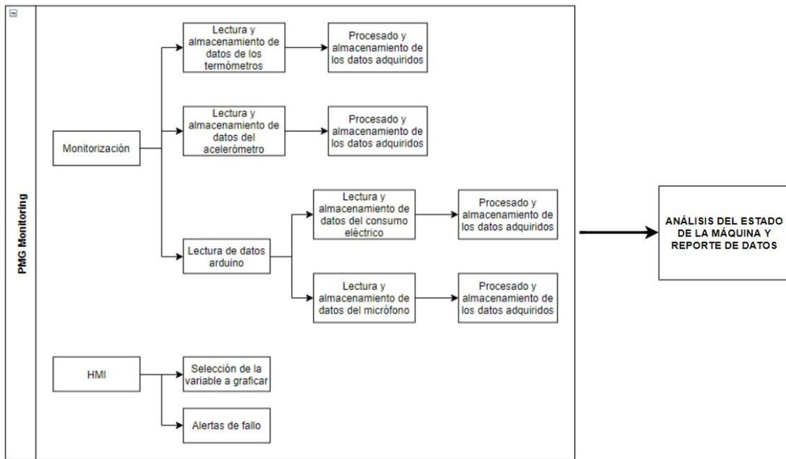
Ilustración 5 - Esquema firmware
