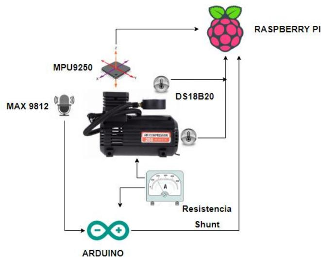
Ilustración 16 - Esquema montaje
