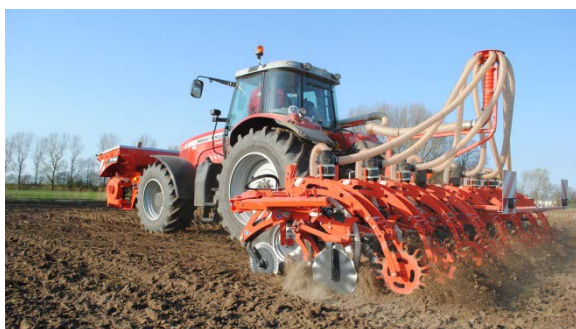
Figura 3. (Izquierda) Imagen de apero Strip-till con el kit de abonado mineral (imagen cedida por Kuhn).
