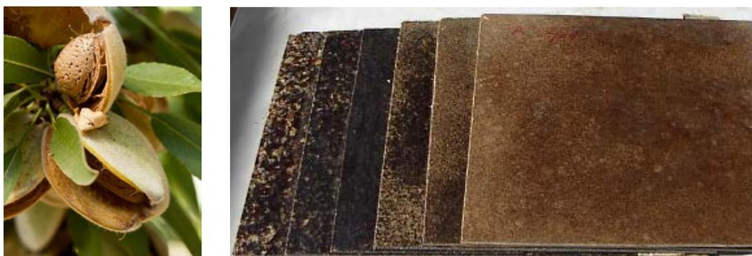
**Figura 1.** Cascos de almendra (exocarpo y mesocarpo) y tableros de partículas obtenidos sin adhesivos.
