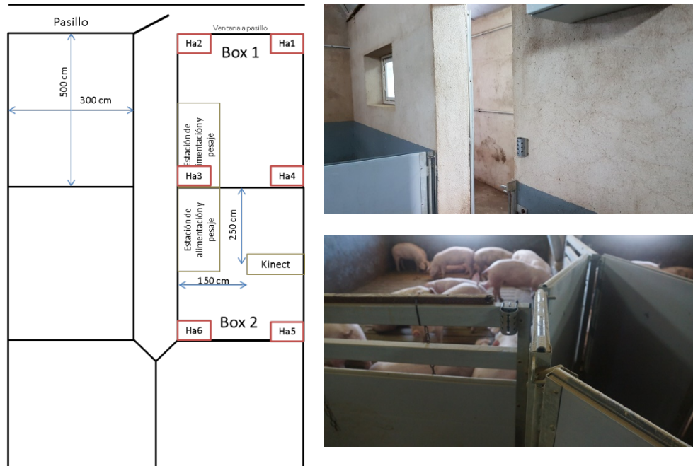
Figura 3. Plano de distribución de los sensores ambientales y detalle de la instalación de dos sensores (Ha2 y Ha6 en el mapa).
