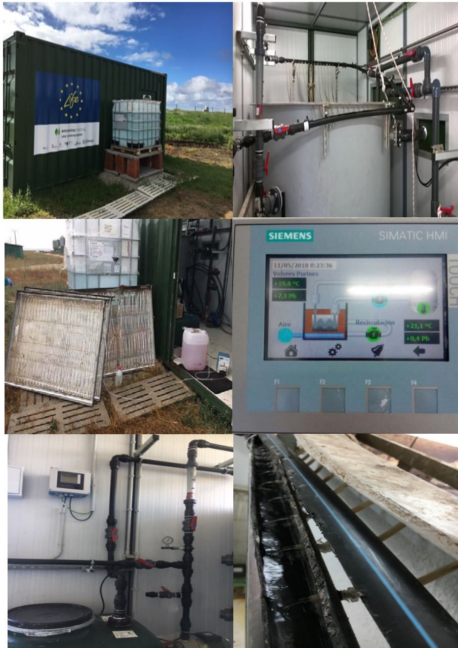
Figura 1. Vista general del prototipo, tanque de purín, paneles con las membranas, panel de control, tanque de solución ácida, salida de la solución ácida de cada panel.
