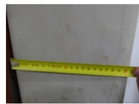
Foto 8. Comprobación in situ de espesor
