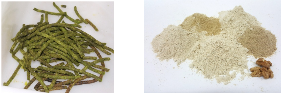
Figura 1. Aspecto externo del pelet (prensa de tornillo) resultante del proceso de extracción, y de la harina de nuez desgrasada, tras su trituración.
