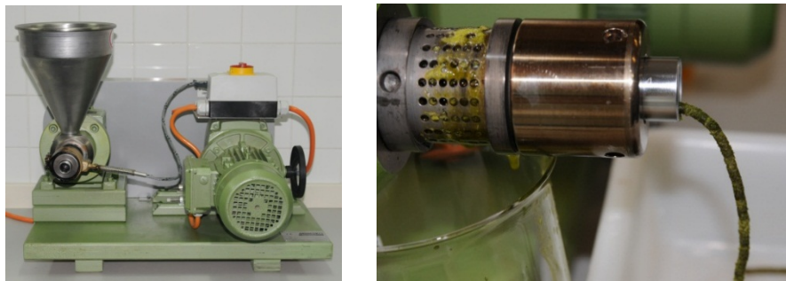
Figura 3. Prensa de tornillo. Aspecto externo y detalle de la boquilla en funcionamiento.
