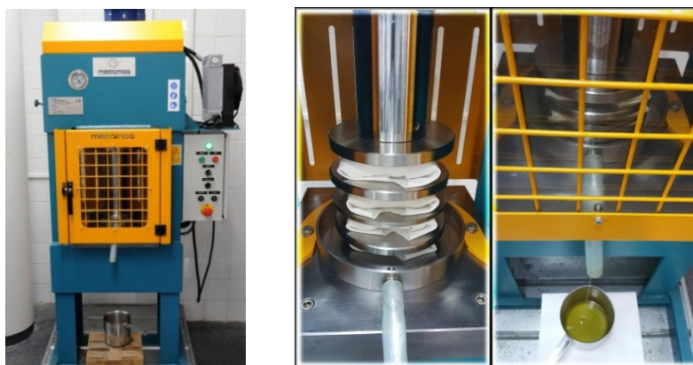
Figura 2. Prensa hidráulica. Aspecto externo y detalle interior.
