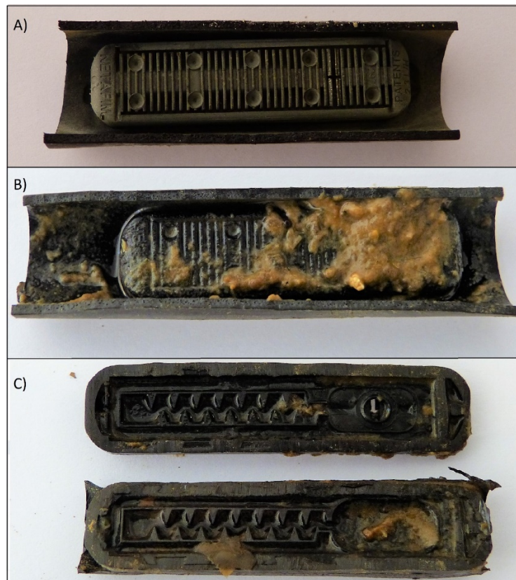
Figura 7. Vista exterior de los goteros protegidos por el diseño de medio poroso en la primera localización (A) y en la última (B), y vista interior de este último emisor (C) pasadas las 1000 h de ensayo.
