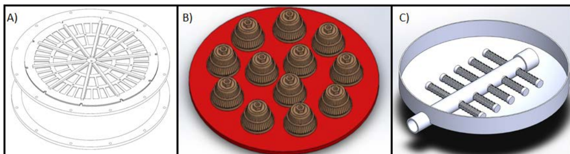
Figura 1. Diseños de drenajes utilizados: medio poroso (A), cúpulas insertadas (B) y brazos colectores (C).
