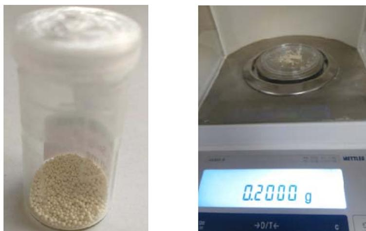
**Figura 35. Pesaje:** Izquierda, bote con las esferas. Derecha, balanza de precisión pesando 200 mg en placa RODAC.
