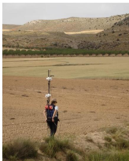
**Fig. 1.-** Adquisición de datos con magnetómetro de efecto Overhauser (GSM-19)
