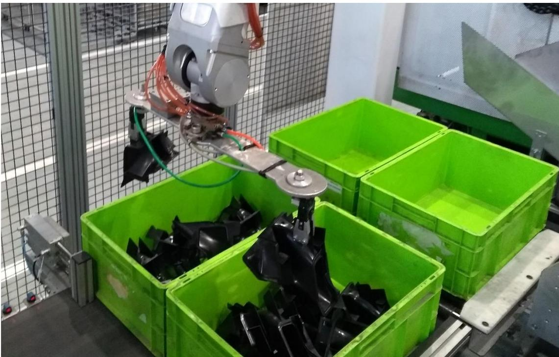
*Fotografía 25: Robot colocando piezas a granel*
