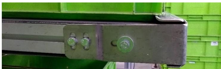
*Fotografía 8: Detalle encaje de cajas en protector*
