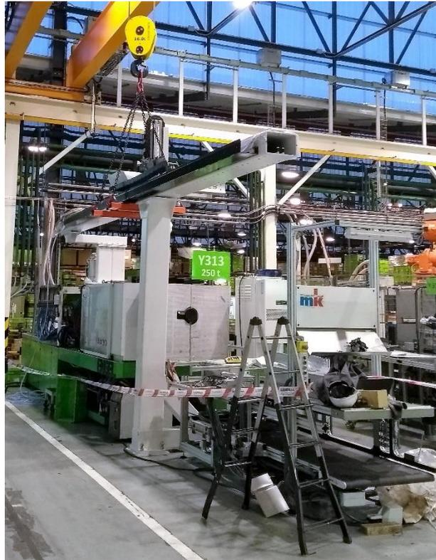
*Fotografía 16: Colocación del robot sobre pie*
