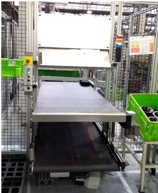
En la fotografía 9 se pueden observar los distintos elementos que están de cara al usuario. La botonera en la izquierda, la balda portadocumentos a una altura de 1400 y la plancha metálica para la colocación de documentación a la altura de la cabeza.
