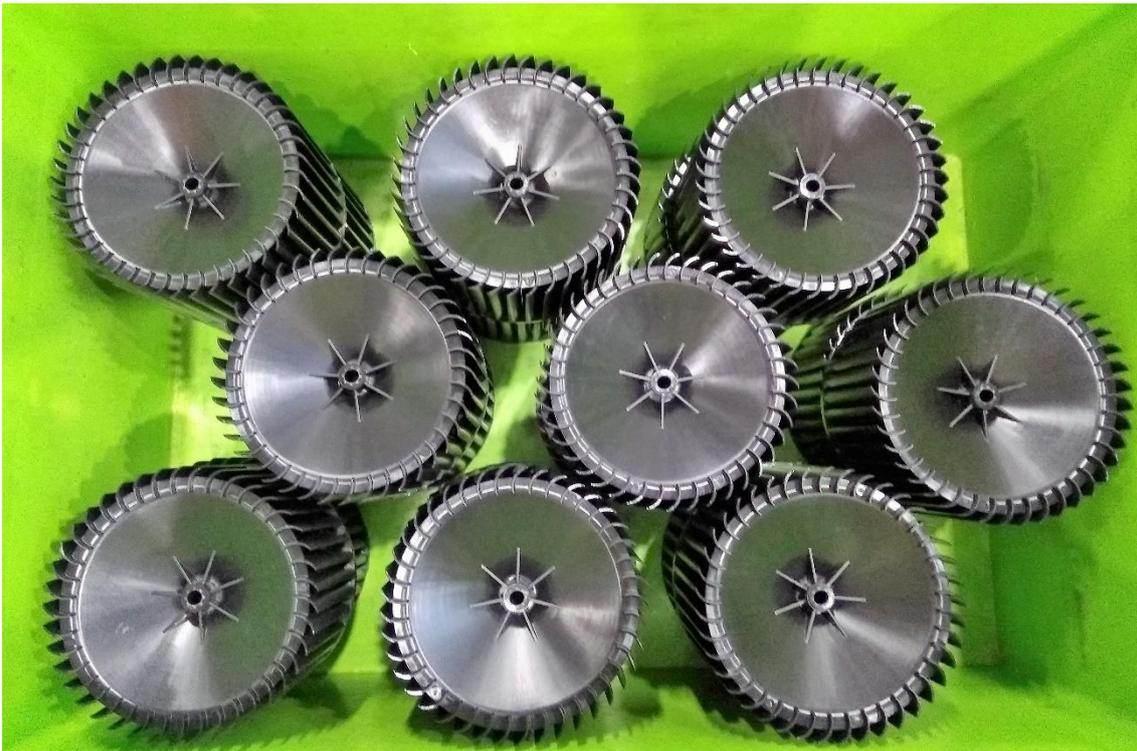
*Fotografía 23: Ejemplo de colocación en la caja de una turbina*
