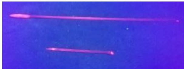
Figura 10. Rubís de la figura anterior iluminados con luz ultravioleta.
