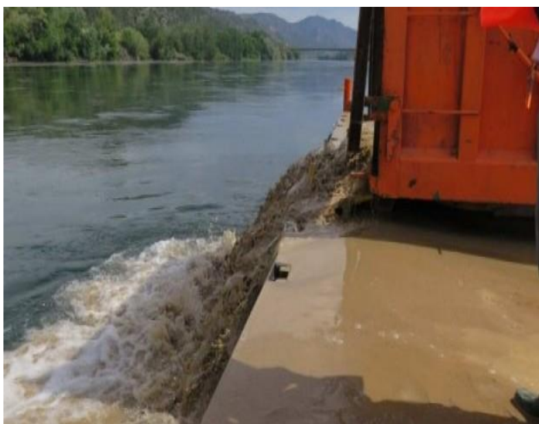
Figura 4: Método de vertido de sedimentos mediante barcaza en las pruebas piloto realizadas por el IRTA sobre el cauce del río Ebro en Mora de Ebro y en Benifallet.
