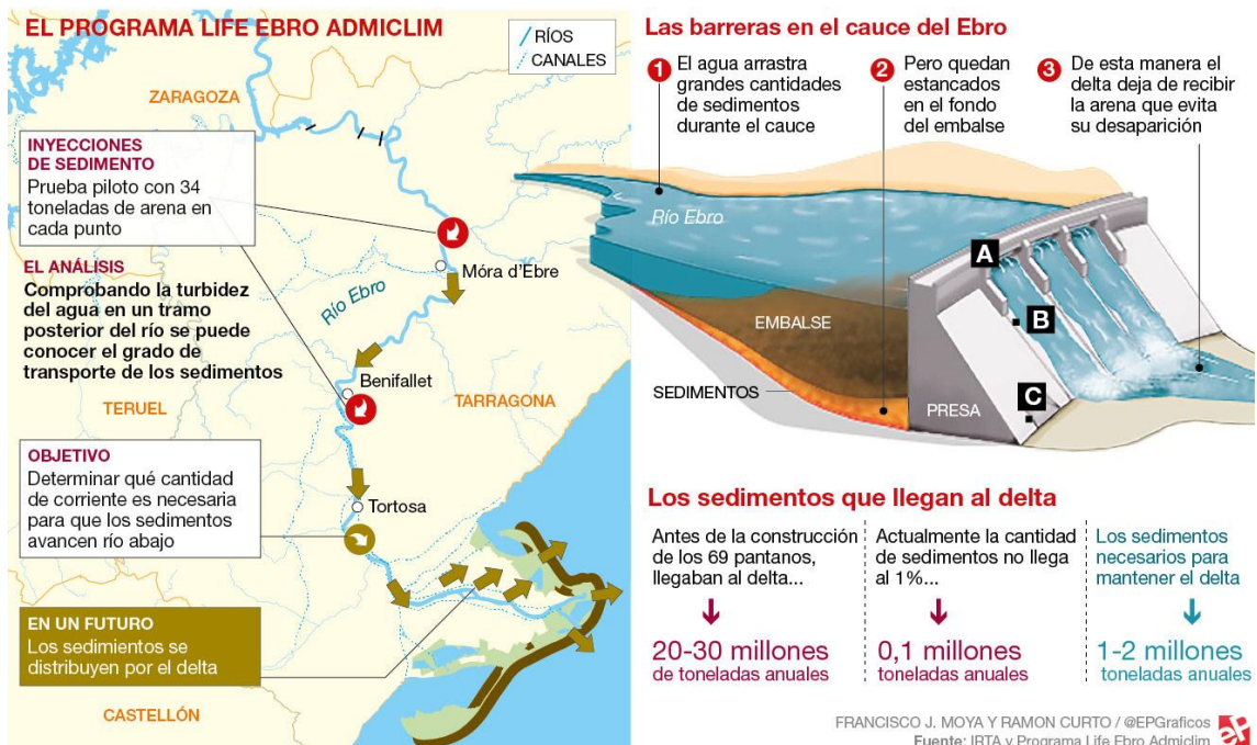
Figura 6: A la izquierda, ubicación de los puntos donde se vertió el sedimento en las pruebas piloto realizadas por el IRTA. A la derecha, esquema de una presa indicando las zonas donde se deposita el sedimento. (Imagen sacada de “el Periódico” 24-05-2017).
