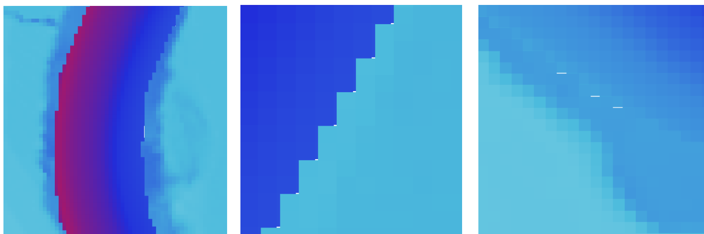
Figura 41: Detalles de píxeles en blanco a lo largo de las orillas del río, justo en las partes donde se solapan los rásteres de las márgenes con los del cauce.
