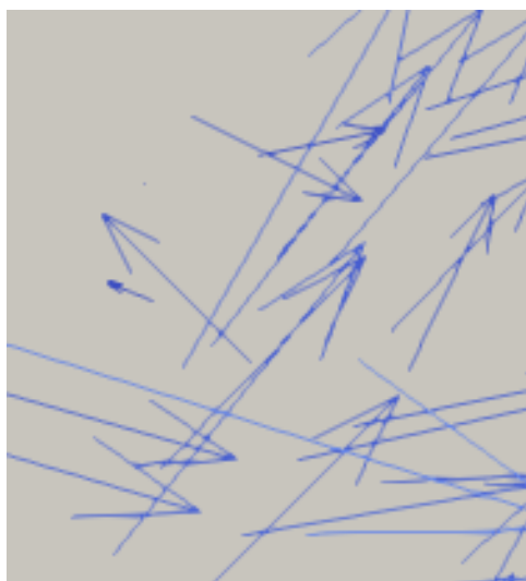
Figura D.7: Dirección del flujo en un sector de Castejón de Ebro mediante la representación gráfica de los vectores velocidad
