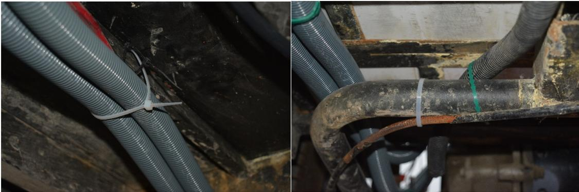
*Figura 8. Cables y mangueras sujetas al chasis*
