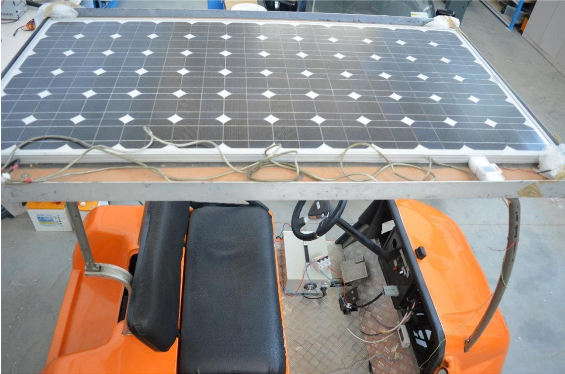
*Figura 17. Vista superior de la placa solar instalada en el vehículo*
