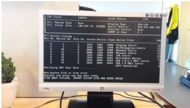
Figura B. 3 Interface del sistema embebido que muestra el error en el disco de arranque tras activar el interruptor de alimentación del mismo.
