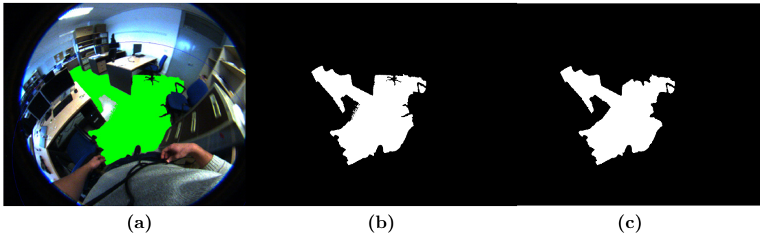
Figura 5.3: (a) Resultado de la segmentación del suelo de la escena. (b) Máscara del suelo segmentado. (c) Máscara del suelo segmentado eliminando los puntos de zonas no transitables
