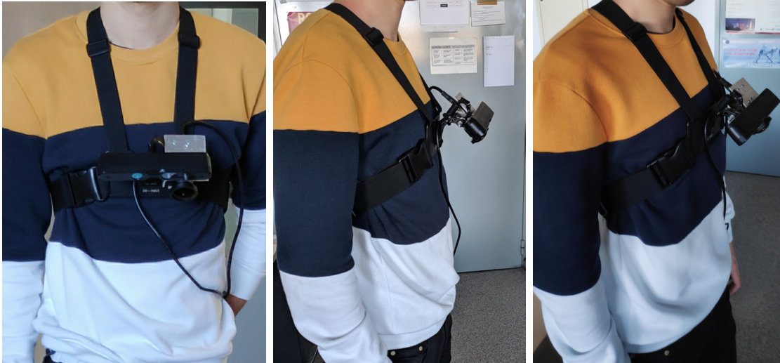
Figura 3.3: Posicionamiento del sistema de cámaras sobre el sujeto
