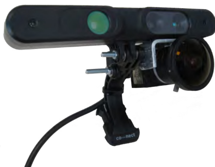
Figura 2.1: Sistema de cámaras utilizado en este proyecto en el que se combinan la cámara fisheye y la cámara RGB-D
