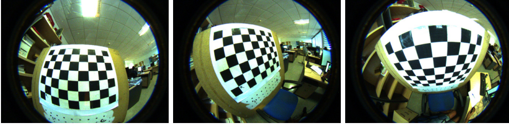
Figura 2.3: Muestra de algunas de las 21 imágenes tomadas mediante la cámara fisheye del patrón tipo ajedrez para realizar la calibración intrínseca de la misma
