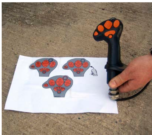
Foto 12. Joystick para manejo desde cabina.
