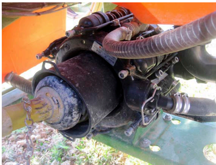
Foto 3. Bomba de impulsión de 6 membranas.
