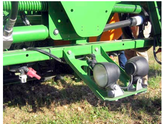
Foto 6. Iluminación de la barra portaboquillas. Trabajo nocturno.
