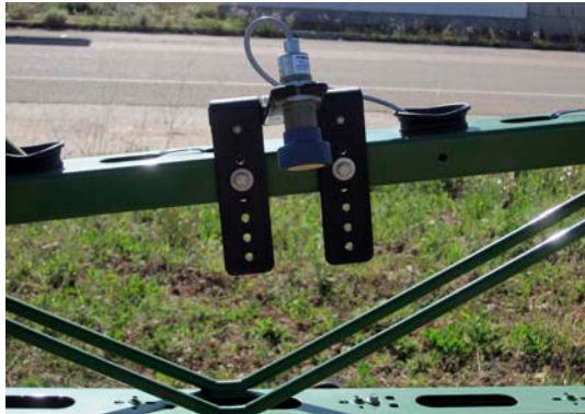
Foto 9. Sensor de ultrasonidos para altura de barra.
