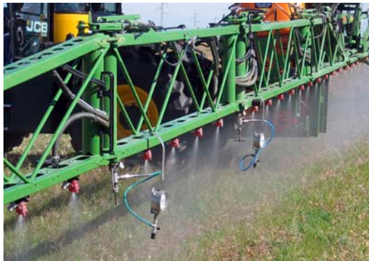
Foto 15. Manómetros colocados en final de sectores para ensayo de pérdida de presión.
