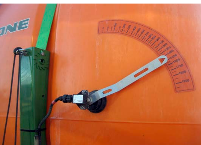
Foto 2. Indicador de nivel. Analógico y conexión para digital.
