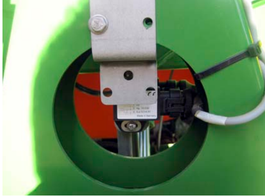
Foto 8. Inclinómetros instalados en el centro de la barra.
