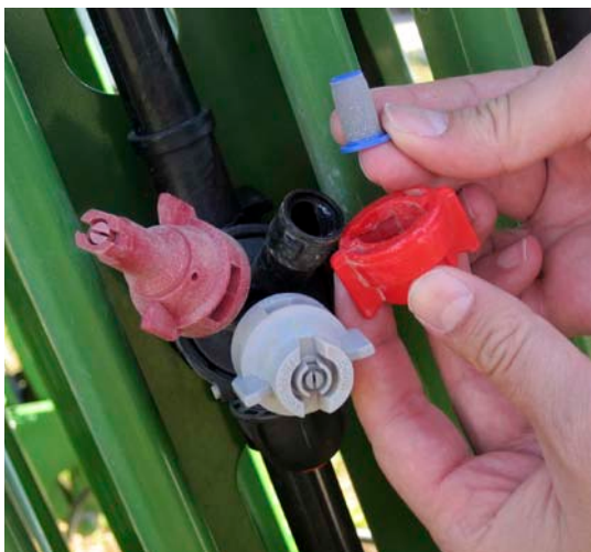
Foto 7. Boquillas y filtro de boquilla.
