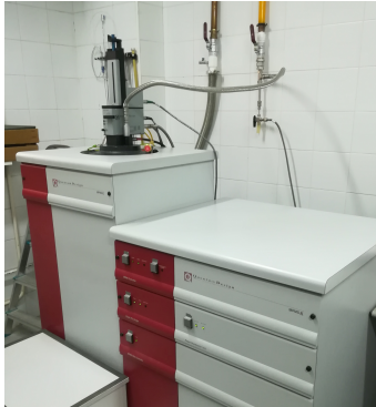
Figura 2: Instalación del SQUID en el MPMS (izquierda) y esquema del anillo del SQUID con las dos uniones Josephson (derecha). El esquema no está a escala. El anillo es mucho mayor en tamaño que las dos uniones.
