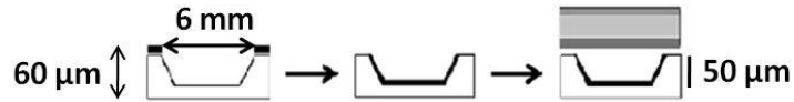
Figura 12. De izquierda a derecha: litografía óptica sobre oblea de silicio para el grabado de los micro-preconcentradores, espineado para la incorporación del material adsorbente, y sellado con la cubierta grabada en la oblea de Pyrex
