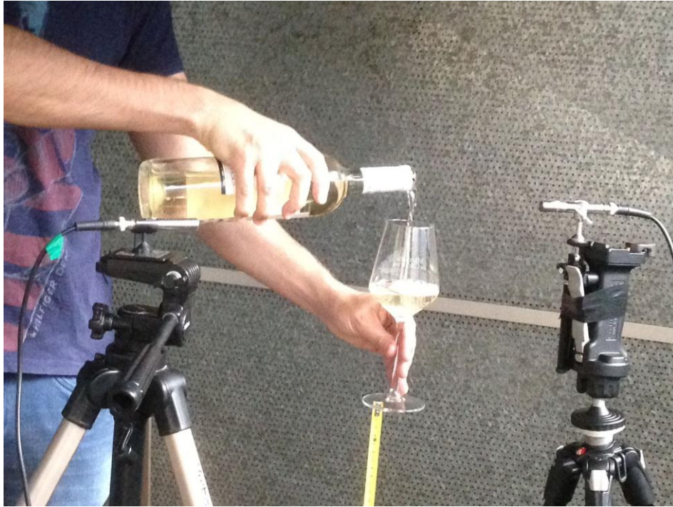
Imagen 43: Medición VBC1S para vino blanco para copa 1 en situación de servicio sujeta
