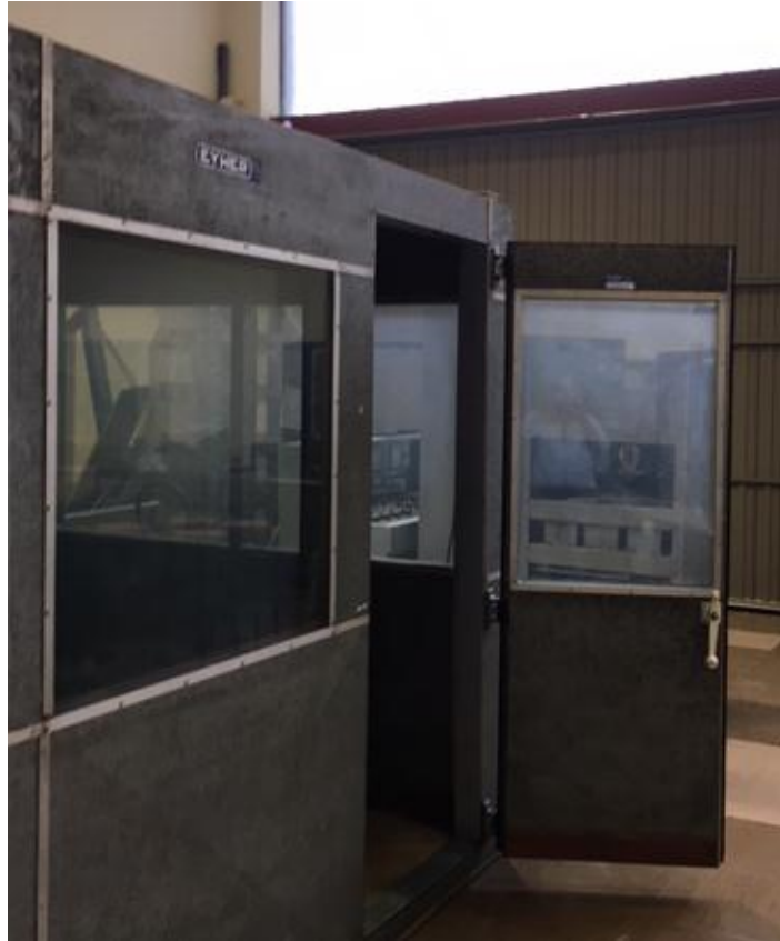
Imagen 25: Detalle de la puerta acústica de la cámara
