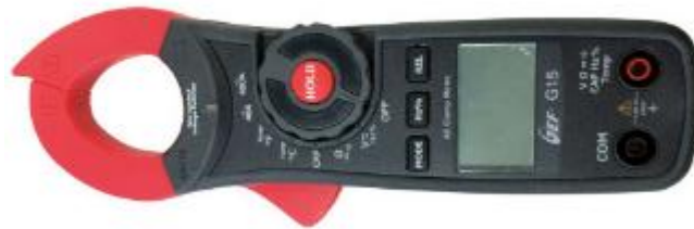
Imagen 47: Pinza amperimétrica utilizada en los ensayos 37
