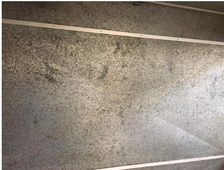
Imagen 24: Detalle del recubrimiento absorbente (láminas perforadas) del interior de la cámara
