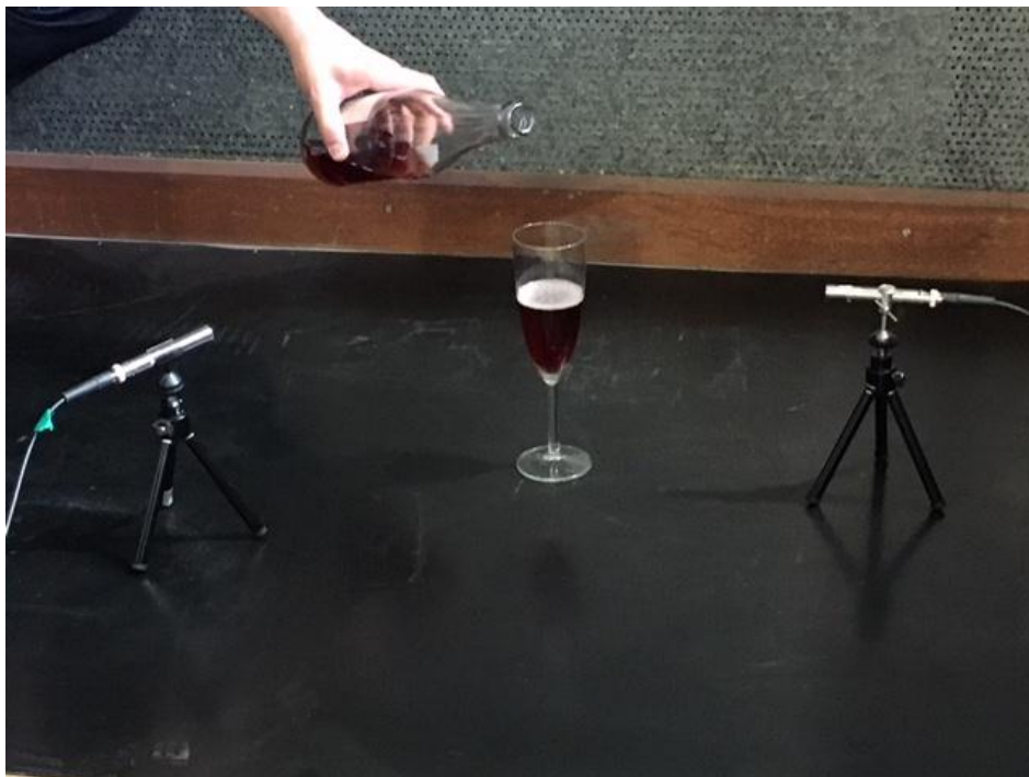
Imagen 42: Medición VEC3A para vino espumoso (Lambrusco) para copa 3 en situación de servicio apoyada
