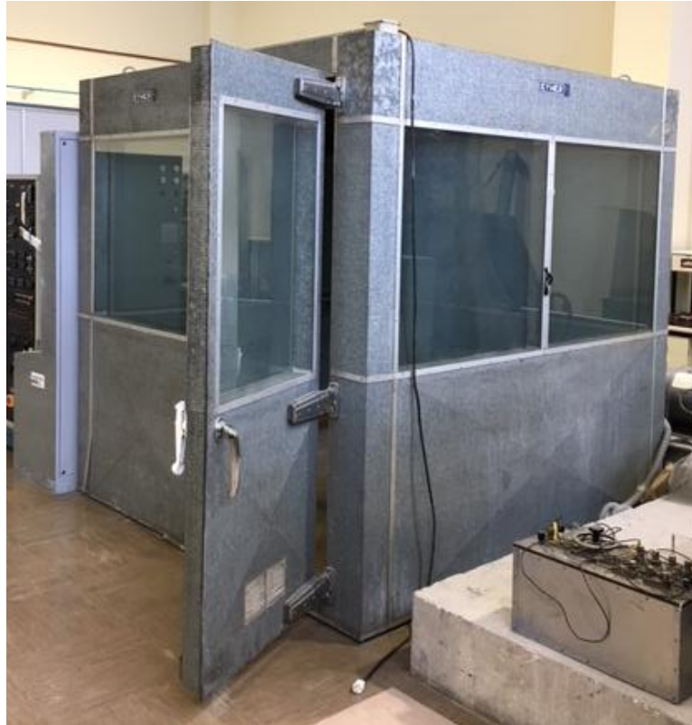
Imagen 23: cámara utilizada para los ensayos acústicos
