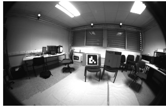
(b) Imagen tomada con una cámara gran angular con un FOV de \sim 180^\circ . Nótese la presencia de una fuerte distorsión de barril.
