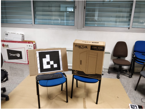
(a) Imagen tomada con una cámara pinhole con un FOV de \sim 80^\circ . Nótese que las rectas aparecen rectas.
