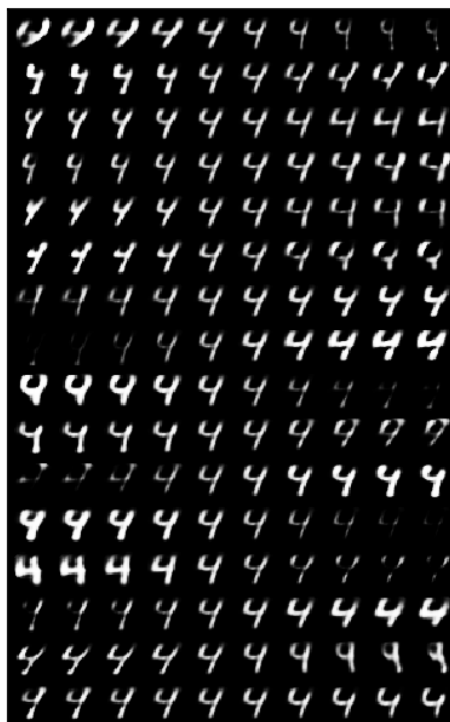
Figura 2.5: Reconstrucción de la imagen de entrada a la red de cápsulas sumando a la amplitud de cada dimensión en 10 pasos, uno por cada columna, un valor en el rango [-0.5, 0.5] . Hay una fila por cada una de las 16 dimensiones de la cápsula de clase. Observamos que, para variaciones grandes, no se llega a reconstruir nada o se pueden llegar a reconstruir aberraciones que no se parecen al dígito original.
