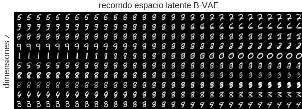
Figura D.1: Reconstrucciones de \beta -VAE para valores de cada dimensión de z equiespaciados en el rango [-3, 3] .
