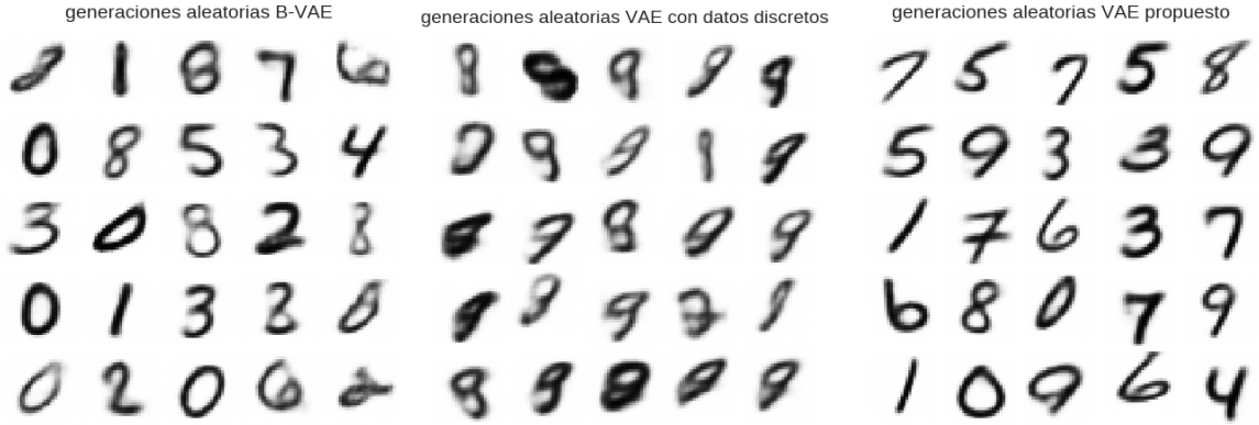
Figura 4.8: Reconstrucciones para muestras aleatorias del espacio latente tomadas de N(0, I) . Las variables discretas se muestrean de una distribución multinomial con clases equiprobables. Observamos que la dependencia entre el espacio latente y continuo del segundo modelo causa la reconstrucción de aberraciones. El modelo propuesto tiene la flexibilidad para captar mejor el manifold de los datos. Genera reconstrucciones de mayor calidad que los otros dos. La independencia de las variables discretas de las continuas tanto de clase como compartidas hace que cualquier combinación regenere un dígito correctamente.
