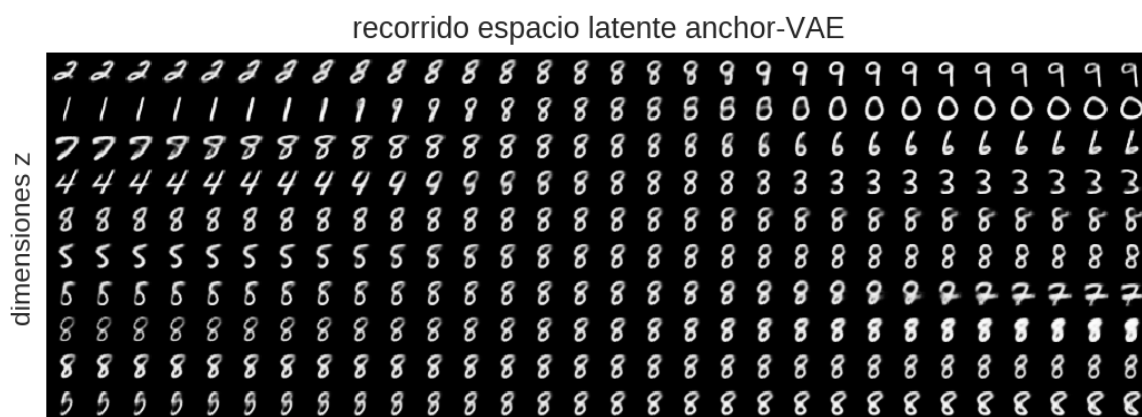
Figura 4.11: Reconstrucciones de anchor-VAE para valores de cada dimensión de z equiespaciados en el rango [-3, 3] . Observamos que, a pesar del uso de la técnica de desentrelazado, la información de clase se distribuye por múltiples dimensiones. La única dimensión completamente desentrelazada es la octava, la cual codifica el grosor de trazo.
