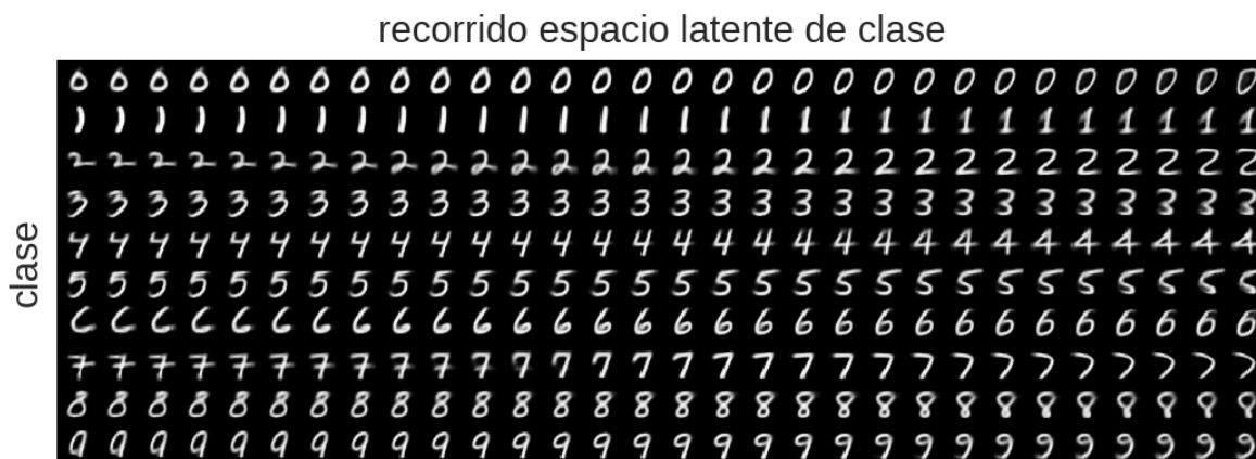
Figura 4.9: Reconstrucciones con nuestro modelo propuesto para valores de z_c equiespaciados en el rango [-3, 3] . Asignamos una dimensión a cada clase. Fijamos z_s=0 . Observamos que cambiando el vector indicador de clase, modificamos el dígito que se regenera. El valor de la dimensión de clase regula variaciones en la forma del dígito reconstruido exclusivas a la clase seleccionada.
