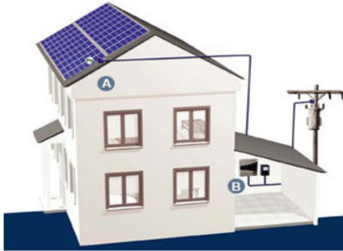
*Figura 4: kit de conexión a red para autoconsumo.*
