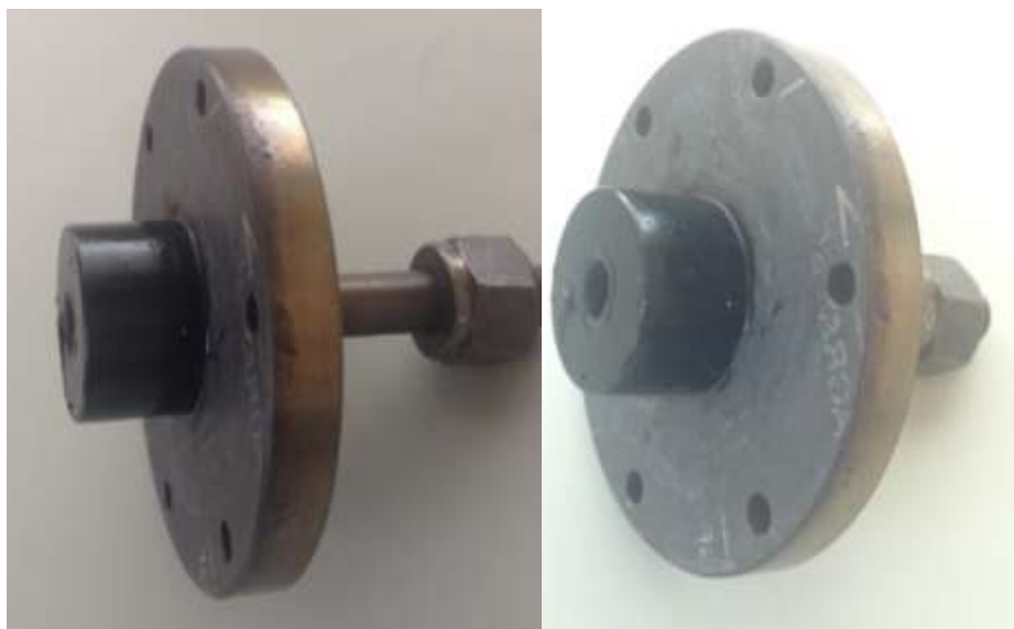
Ilustración 4. Filtro en caliente con condensado en la estructura
