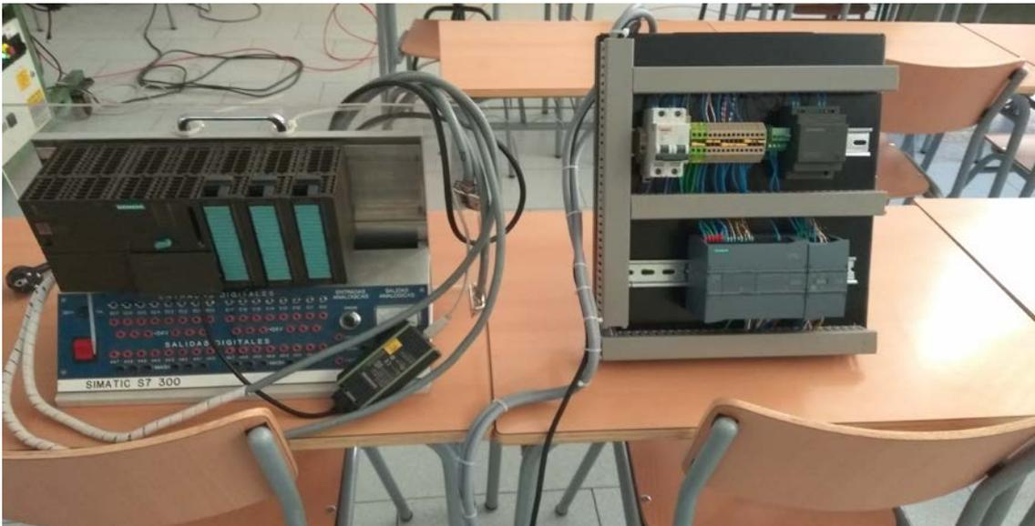
*Imagen 3. Comparación entre el módulo antiguo (izquierda) y un nuevo módulo (derecha) con el autómata Siemens SIMATIC S7-1200*
