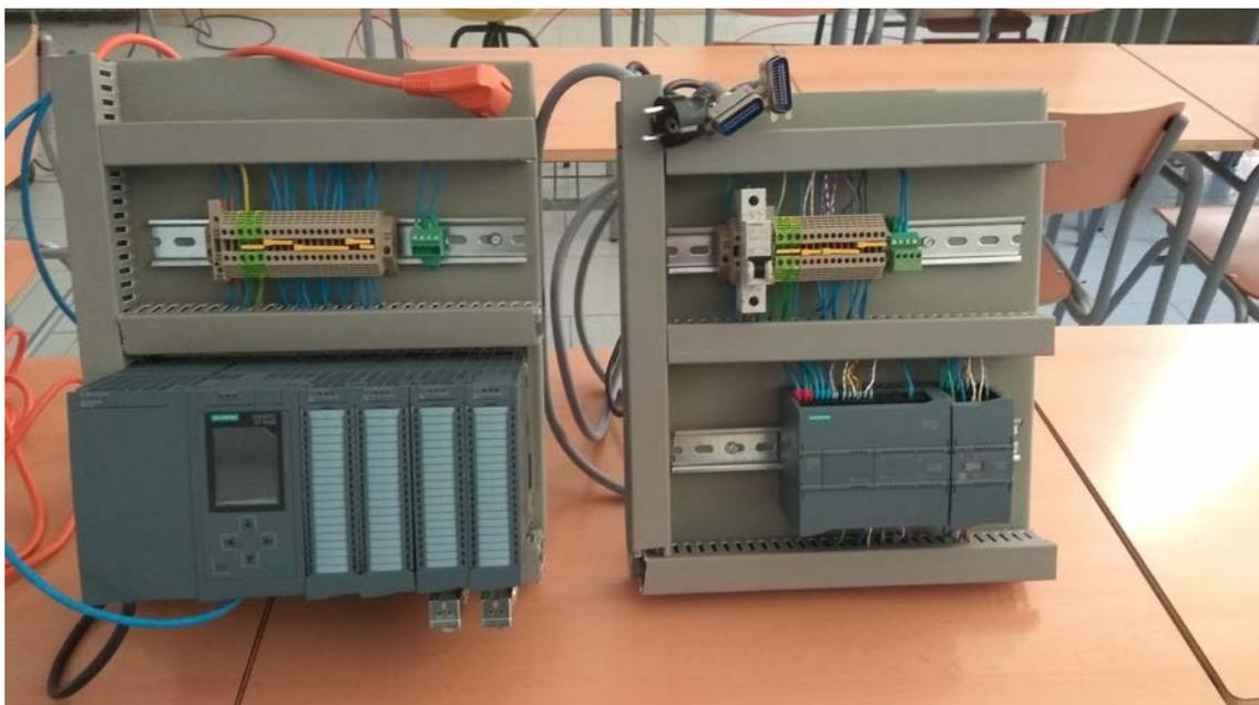
*Imagen 4. A la izquierda tenemos el módulo de control con el autómata Siemens SIMATIC S7-1500 y a la derecha el autómata Siemens SIMATIC S7-1200*
