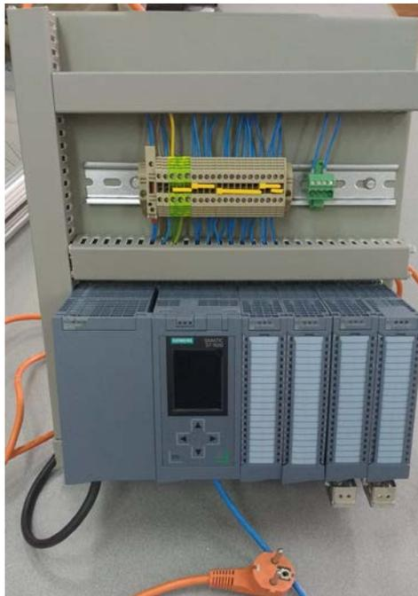
*Ilustración 1 PLC 1516F PN/DP con tarjetas de E/S digitales y analógicas + fuente de alimentación.*
