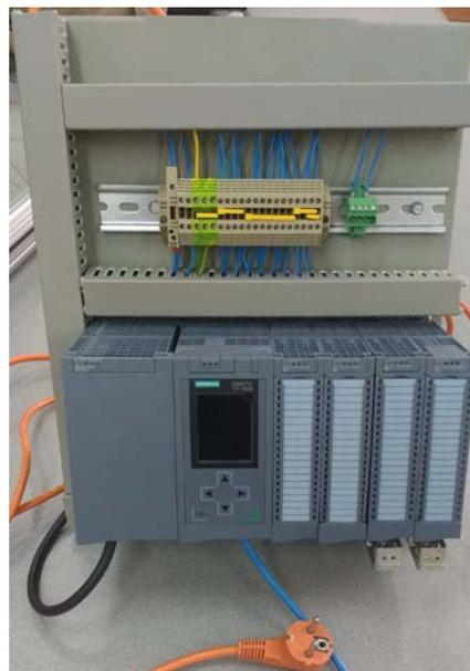
*Imagen 8. Módulo de control PLC 1516F PN/DP con tarjetas de E/S digitales y analógicas + fuente de alimentación.*
