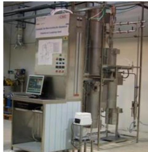
Figura 3.7. Esquema y fotografía de la planta piloto CLC de 1 kW<sub>t</sub> para combustibles líquidos.
