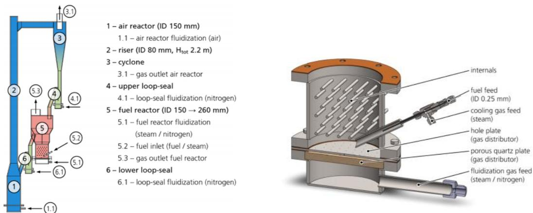
**Figura 1.26.** Esquema del reactor CLC de 10 kW<sub>t</sub> y sistema de inyección de combustibles construidos en la Universidad Tecnológica de Chalmers, Suecia, [Moldenhauer y cols., 2014a]
