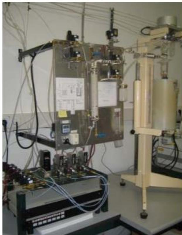
Figura 3.3. Esquema y fotografía del equipo termo-gravimétrico.
