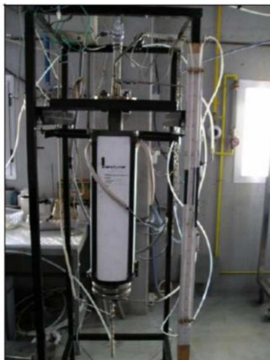
Figura 3.4. Esquema y fotografía de la instalación de lecho fluidizado discontinuo
