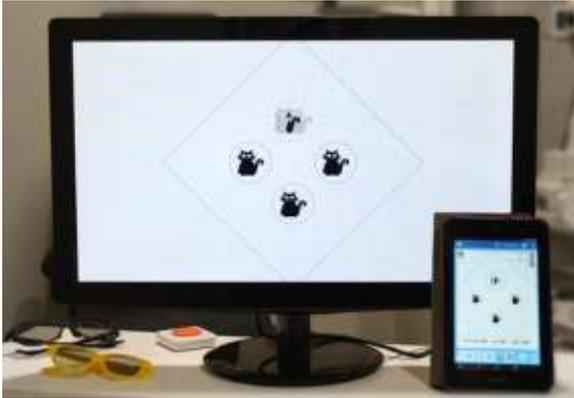
**Figura 8.** Unidad de OptTab para la realización de la medida de la estereopsis en lejos.
