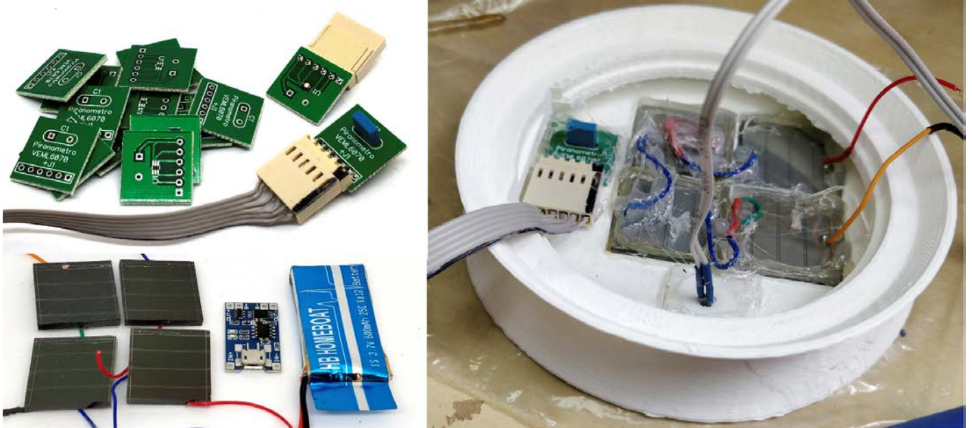
Fig. 73 Detalle del montaje de los distintos elementos en la carcasa
