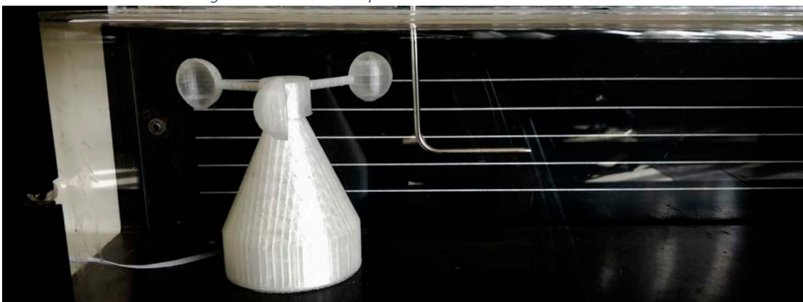
Fig. 48 Medición de velocidad mínima mediante tubo de Pitot
