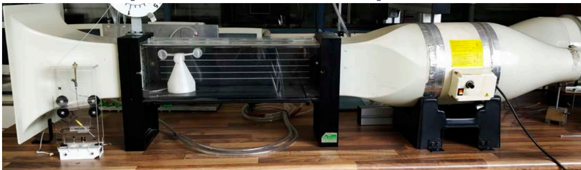
Fig. 47 Túnel de viento para caracterizar el anemómetro
