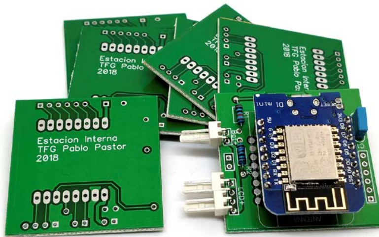
Fig. 78 PCB del módulo interno
