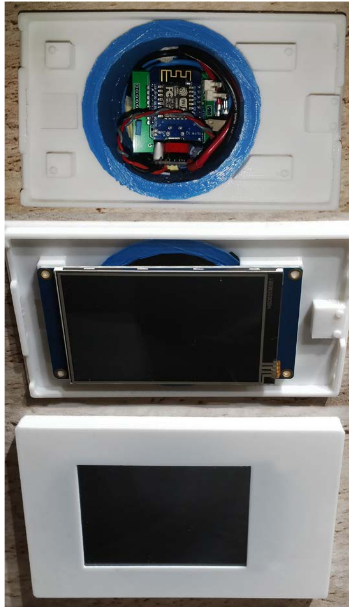
Fig. 80 Instalación del módulo interior empotrable en una vivienda real
