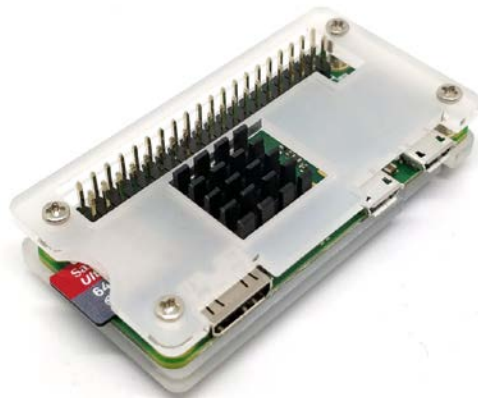
Fig. 81 Imagen del servidor central, Raspberry Pi Zero W
