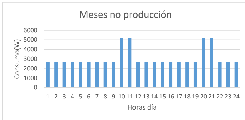
Figura 8. Perfil de consumo medio diario de una granja ovina en los meses de no producción. Fuente propia.
