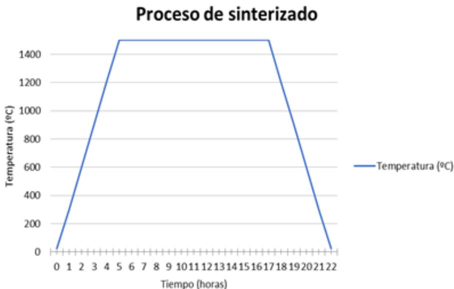
Figura 2. Gráfica representativa del proceso de sinterizado.
