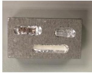
Figura 5. Muestras colocadas en el portamuestras para posterior análisis.
