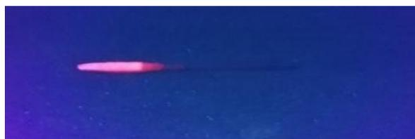
Figura 12. Rubí crecido por fusión zonal en atmosfera de aire iluminado con luz ultravioleta.
